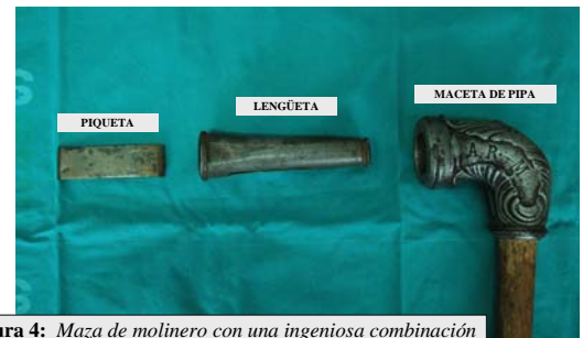
Figura 4: Maza de molinero con una ingeniosa combinación de piezas que permite el recambio de la piqueta cuando se desgasta
